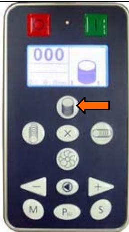
Die Stapel-Funktion ist eingestellt. Durch erneutes Drücken der Funktionstaste (Stapeln) erscheinen im Display drei Balken.
