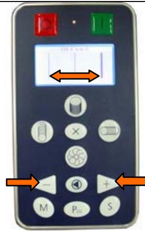
Über die Plus „+“ und Minus „-“ Taste kann die Position des markierten Balkens verändert werden und die Ablageposition des Schneidgutes wird auf dem Tablett dementsprechend verschoben.
