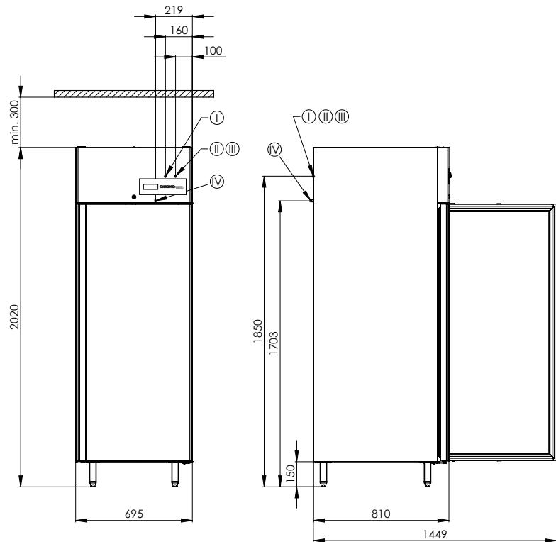
**I** Steckerfertige Umluftkühlung
