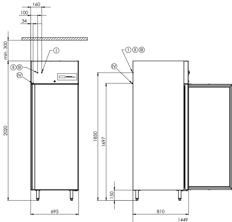
**I** Steckerfertige Umluftkühlung
