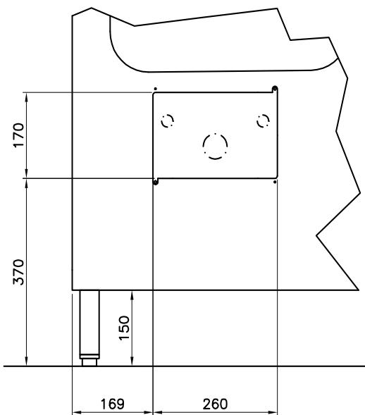
Leicht zu öffnende Ausspaarung zum Anschluss vom Wasserablauf/Siphon sowie Kalt- und Warmwasseranschluss.
